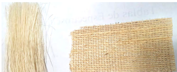
Figura 1. Membranas de cabuya recubiertas con nanopartículas de plata.
